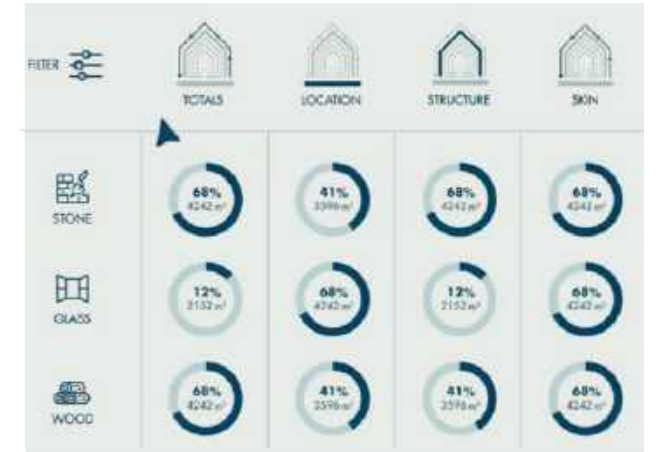
Een materialenpaspoort geeft inzicht in de circulariteitswaarde van een gebouw (referentie: Madaster)
