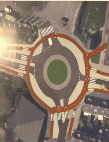
Pijlslaan - Stephensonstraat Variant 1 - aanpassen bestaande rotonde
